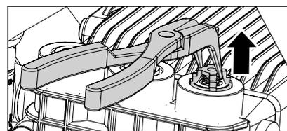
Retire con una pinza de punta el cuerpo de válvula (con revestimiento de plástico de color verde o rojo) junto con el anillo toroidal. Controle el anillo de obturación en cuanto a deterioro. En caso de deterioro se debe cambiar el anillo toroidal.
