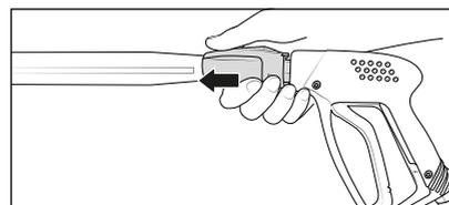
7. Después de insertar la lanza, debe soltarse el manguito de seguridad y prestarse atención a que el alojamiento de la lanza sea seguro. **Lubricar periódicamente la boquilla enchufable con una grasa libre de aceites.**
