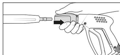
6. El manguito de pistola de desconexión de seguridad debe primero retirarse y luego introducirse la lanza en el acoplamiento insertable de la pistola de desconexión de seguridad.
