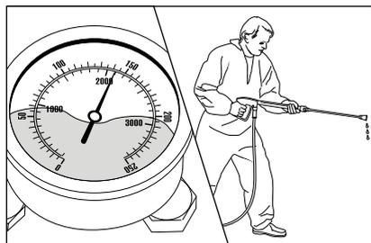
El manómetro de acero fino indica presión plena. De la lanza no sale agua o solamente muy poca.
