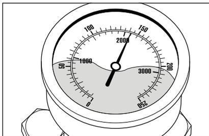
Después de cerrar la pistola con desconexión de seguridad la hidrolimpiadora de alta presión debe desconectarse. El manómetro de acero fino debe indicar "0" bares. Si no funciona la desconexión y el manómetro de acero fino sigue indicando que funciona a presión plena, la causa puede residir en una fuga en la bomba de alta presión, en el interruptor de presión, en la manguera de alta presión o en la pistola de desconexión de seguridad con desconexión automática.
