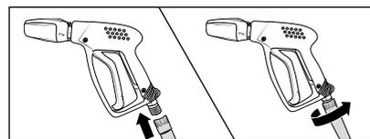
5. Conecte la atornilladura giratoria de color gris de la manguera de alta presión a la pistola de desconexión de seguridad. A continuación, enrósquelas fuertemente y a presión.
