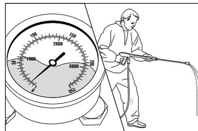
El manómetro de acero fino indica a pesar de regulación de presión abierta solamente poca presión. De la lanza sale un chorro irregular. La manguera de alta presión vibra.
