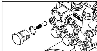
Retirar el cuerpo de retención y comprobar que la junta tórica no presente suciedad o deterioro. Compruebe llegado el caso el alojamiento hermético en el válvula de control para determinar que no presente suciedad o daños.
