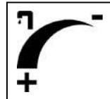
Símbolo que indica el funcionamiento del grifo de regulación del flujo de la solución detergente.
