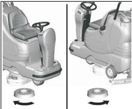
Se aconseja invertir a diario la posición de los cepillos al fin de garantizar una utilización más duradera. Si los cepillos tienen las cerdas inevitablemente deformadas es mejor volver a montarlos en la misma posición, para evitar que la distinta inclinación de las cerdas cause unas sobrecargas del motor o vibraciones excesivas.
