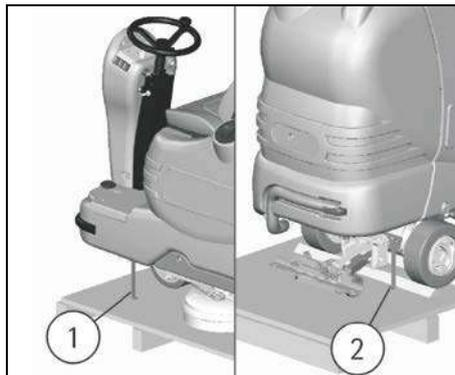
3. Liberar la máquina de la tarima, empujándola en marcha atrás, como indicado en la figura. Evitar choques fuertes en las partes mecánicas.
