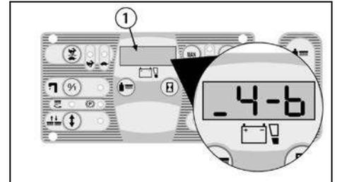
4. El indicador de nivel de carga de las baterías es digital y fija. El nivel de carga de las baterías empieza de -100-, que indica el 100% de la carga completa, marcando cada disminución de 10 en 10. Cuando el estado de carga llega a -20-, el display empieza de parpadear, indicando el final próximo de la carga de las baterías.
