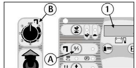
Cuando el conmutador (B) es en posición OFF, se puede poner en función un sistema hidrico auxiliar que permite el empleo tradicional de la máquina y por lo tanto el llenado del depósito de la solución con agua y detergente. En este caso es necesario abrir y regular manualmente el grifo (C) situado debajo la máquina. En esta situación el pulsador (A) maneja el mando de la electroválvula en función manual.
