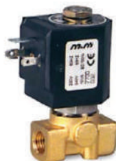
ELECTROVÁLVULA 2/2 NC 200 Bar 24 V AC 1/4" ALTA PRESIÓN
