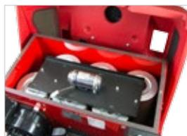
6 filtros tubulares de celulosa con 6 m<sup>2</sup> de superficie que le confieren una de las mayores superficies filtrantes en su segmento de mercado
