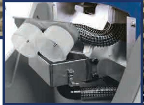
Una gran abertura con bandeja de drenaje de acero asegura una limpieza fácil y profunda del tanque de recuperación.
