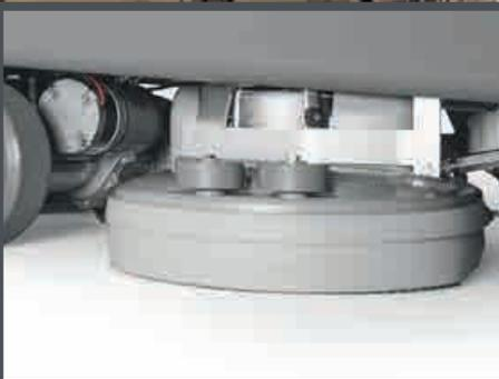
Presión del cepillo regulable mediante sistema electromecánico.
